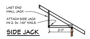
MECHANICAL CONNECTION DEFINED AS NAILS OR SIMPSON HANGERS. MIN. CONNECTION IS 2- 3"x .148".
